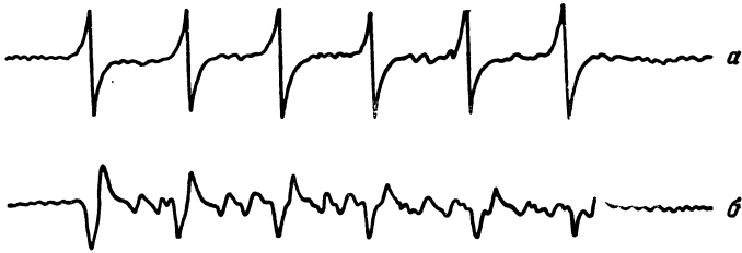
Фиг. 3.23. Спектр формовочной глины на длине волны 1,3 см (а) и 3.2 см (б).
