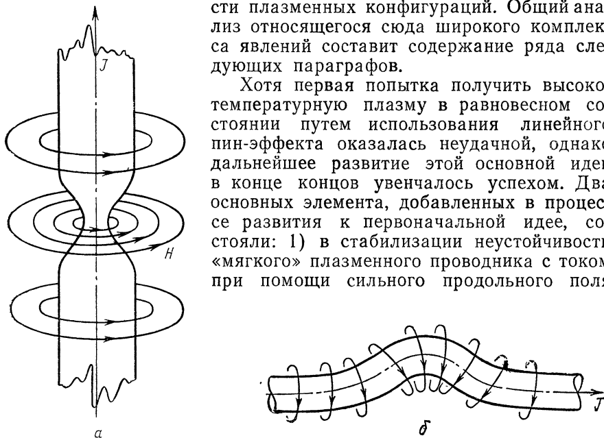
Рис. 2.27. Деформации типа «перетяжка» (а) и «изгиб» (б)
