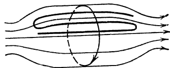
Рис. 2.5. Осевая линия траектории частицы в поле с магнитными пробками
