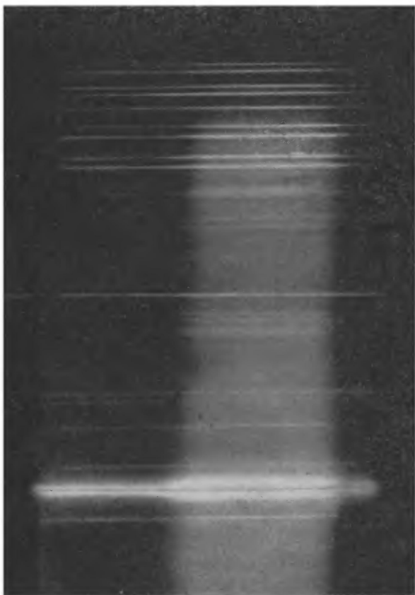
Фиг. 11.5. Разрешенная по времени спектрограмма видимого света, испускаемого газом у торцевой стенки ударной трубы.
