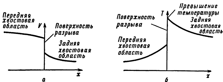
Фиг. 8.10. Решение для случая частично диспергированной ударной волны в излучающем газе.
