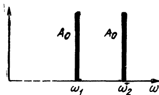
Рис. 10.1. Спектральная диаграмма простейшего немонохроматического колебания.
