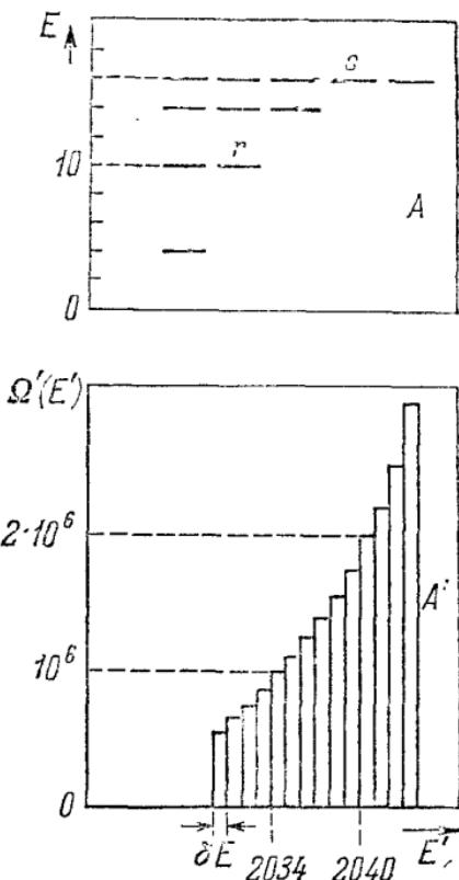
Рис. 4.6. Схема доступных состояний некоторой системы  $A$  и специального (очень маленького) теплового резервуара  $A'$ . На верхней части рисунка показаны уровни энергии для нескольких состояний системы  $A$ , на нижней — число доступных состояний  $\Omega'(E')$  системы  $A'$  в зависимости от ее энергии  $E'$ . Энергия измерена в произвольных единицах.
