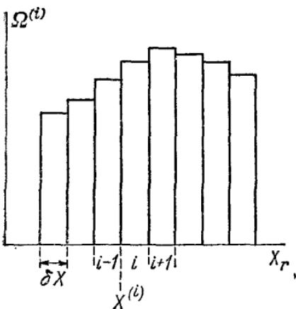
Рис. 7.1. Зависимость числа  $\Omega^{(i)}$  состояний, для которых  $X_r \equiv \partial E_r / \partial x$  находится в интервале между  $X^{(i)}$  и  $X^{(i)} + \delta X$ , от индекса  $i$ , обозначающего номер интервала. Суммирование  $\Omega^{(i)}$  по всем возможным интервалам дает полное число состояний  $\Omega(E, x)$ , имеющих энергию от  $E$  до  $E + \delta E$  при значении внешнего параметра, равном  $x$ .
