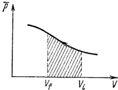
Рис. 5.9. Зависимость среднего давления  $\bar{p}$  от объема  $V$  для некоторой системы. Заштрихованная площадь под кривой соответствует работе, совершенной над системой при квазистатическом уменьшении объема от  $V_i$  до  $V_f$ .
