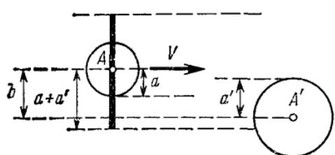
Рис. 8.1. Схема, иллюстрирующая столкновение между двумя твердыми шарами, радиусы которых равны  $a$  и  $a'$ . Черной вертикальной линией обозначен воображаемый диск; его радиус равен  $(a + a')$  и он расположен на сфере с радиусом  $a$ .
