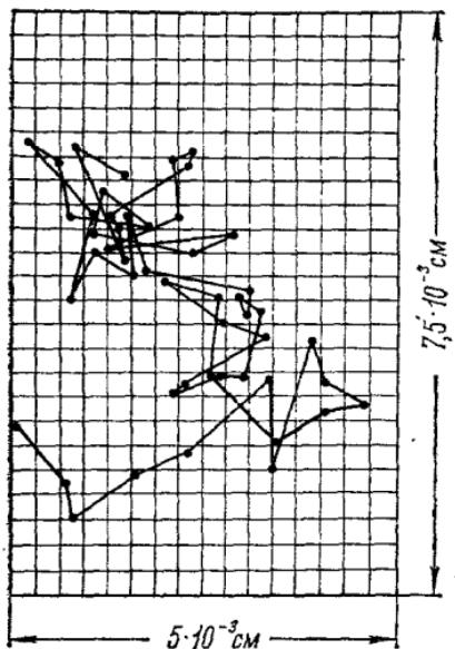
Рис. 1.25. Наблюдаемое под микроскопом броуновское движение частиц, взвешенных в капле воды. Диаметр частиц  $10^{-4}$  см. На этой диаграмме показано положение частиц в поле зрения микроскопа через каждые тридцать секунд.
