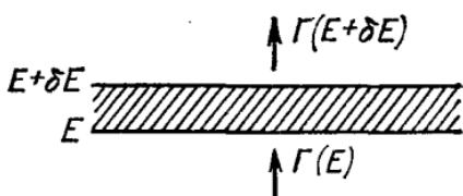
Рис. 7.3. При изменении внешнего параметра число состояний в области энергий от  $E$  до  $E+\delta E$  меняется, так как энергетические уровни различных состояний лопадают в эту область и покидают ее.
