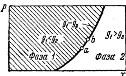
Рис. 7.10. Кривая зависимости давления  $p$  от температуры  $T$ , разделяющая область, где каждая из двух фаз в отдельности может находиться в равновесии. Вдоль кривой возможно совместное равновесное состояние обеих фаз.
