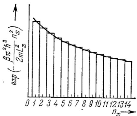
Рис. 4.11. Схема, иллюстрирующая замену суммирования по целым значениям  $n_x$  (сумма равна площади прямоугольников) интегрированием по непрерывным значениям переменной  $n_x$  (интеграл равен площади под кривой).
