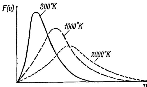
Рис. 6.8. Максвелловское распределение скоростей молекул при различных температурах.
