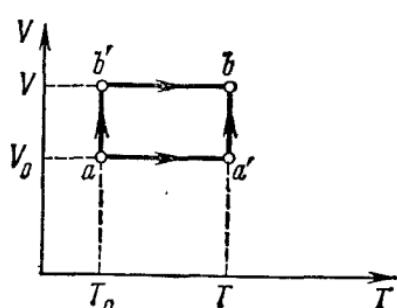
Рис. 7.5. Два различных квазистатических процесса, переводящие систему из начального макросостояния  $a$  (температура  $T_0$ , объем  $V_0$ ) в конечное макросостояние  $b$  (температура  $T$ , объем  $V$ ).
