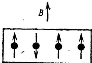
Рис. 2.5. Система из  $N$  спинов, равных  $\frac{1}{2}$ , в частном случае  $N=4$ . Каждая стрелка показывает направление магнитного момента спина. Внешнее магнитное поле обозначено стрелкой  $B$ .
