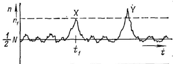
Рис. 1.8. Диаграмма, показывающая редко возникающие большие флюктуации числа молекул  $n$  в одной половине сосуда относительно равновесного значения  $\frac{1}{2}N$ .
