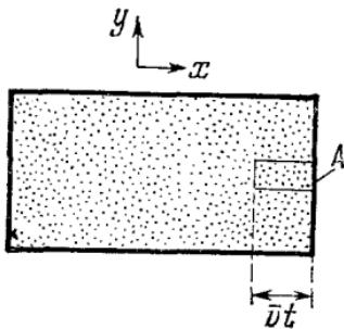
Рис. 1.34. Этот рисунок иллюстрирует столкновение молекул газа с площадкой  $A$  на одной из стенок сосуда. (Ось  $x$  перпендикулярна к плоскости чертежа.)
