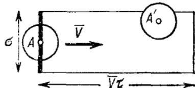
Рис. 8.2. Схема, иллюстрирующая столкновение молекулы  $A$  с другой молекулой, центр которой попадает в объем, образованный движением поверхности  $\sigma$  воображаемого диска, несомого молекулой  $A$ .
