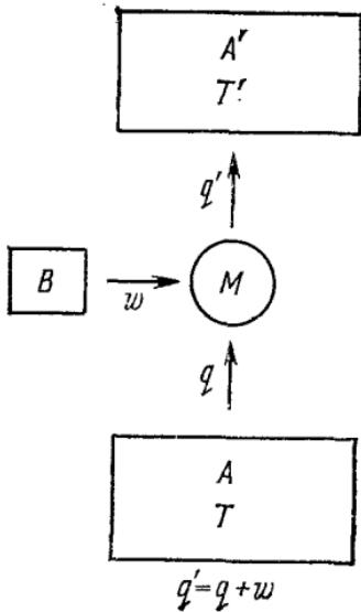
Рис. 7.15. Схема работы холодильника.
