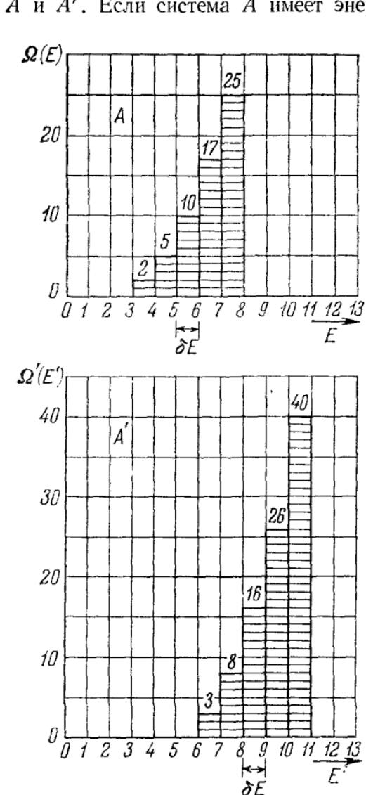
Рис. 4.1. На графиках показано (для частного случая двух очень малых систем  $A$  и  $A'$ ) число состояний  $\Omega(E)$  и  $\Omega'(E')$ , доступных системам  $A$  и  $A'$ , в зависимости от энергии систем  $E$  и  $E'$  соответственно. Энергии измерены в произвольных единицах.
