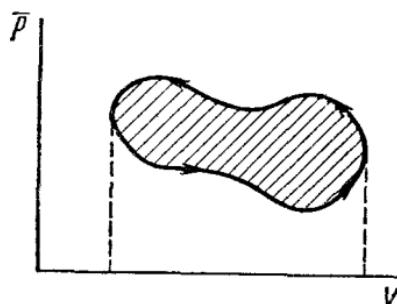
Рис. 5.17. Циклический процесс
