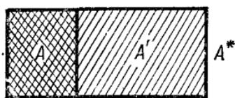
Рис. 3.9. Две системы,  $A$  и  $A'$ , с фиксированными внешними параметрами, которые могут обмениваться энергией. Объединенная система  $A^*$ , состоящая из систем  $A$  и  $A'$ , является изолированной.
