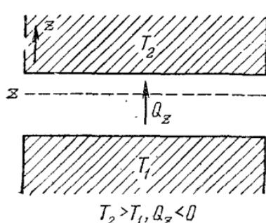
Рис. 3.6. Вещество, находящееся в тепловом контакте с двумя телами, абсолютная температура которых равна  $T_1$  и  $T_2$ . Если  $T_2 > T_1$ , тепло течет в направлении  $-z$ , от тела с большей температурой к телу с меньшей температурой, таким образом, величина  $Q_z$  отрицательна.
