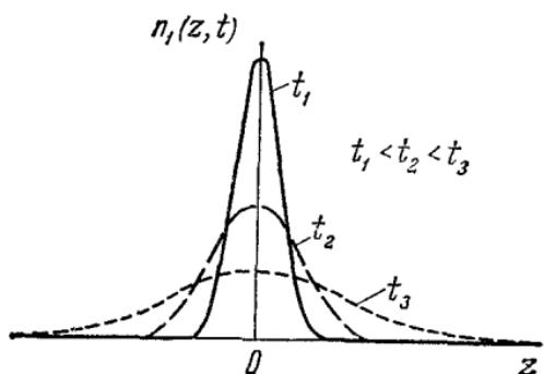
Рис. 8.10. Число  $n_1(z, t)$  меченых молекул в единице объема как функция координаты  $z$  в различные моменты времени. При  $t=0$  молекулы расположены вблизи плоскости  $z=0$ . Поверхность под всеми кривыми одна и та же и равна полному числу  $N_1$  меченых молекул.
