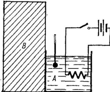
Рис. 5.11. Прямое измерение (в единицах работы) количества тепла  $Q_B$ , поглощенного системой  $B$ . Вспомогательная система  $A$ , состоящая из термометра и сопротивления, может быть сделана очень небольшой по сравнению с системой  $B$ , температура которой измеряется.
