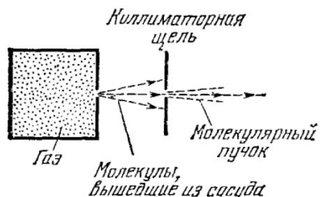
Рис. 1.37. Сосуд, наполненный газом, имеет очень маленькое отверстие, через которое молекулы могут выходить в окружающий вакуум. С помощью одной или нескольких коллиматорящих щелей можно выделить молекулярный пучок. Распределение молекул по скорости определяется распределением в сосуде. Метод молекулярного пучка позволяет изучать поведение изолированных атомов или молекул. Его очень часто используют в современных физических экспериментах.
