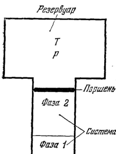
Рис. 7.9. Система состоит из двух фаз и находится в контакте с резервуаром, что обеспечивает постоянную температуру  $T$  и давление  $p$ .
