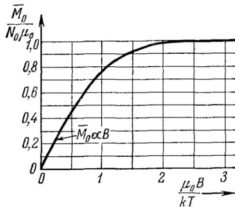
Рис. 4.10. Зависимость намагниченения  $\bar{M}_0$  от магнитного поля  $B$  и температуры  $T$  в случае слабо взаимодействующего атома со спином  $1/2$  и магнитным моментом  $\mu_0$ .
