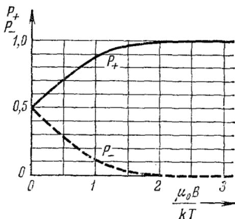
Рис. 4.9. Зависимость вероятности  $P_+$  ( $P_-$ ) того, что магнитный момент  $\mu_0$  направлен параллельно (антипараллельно) внешнему магнитному полю  $B$ , при данной абсолютной температуре  $T$ .
