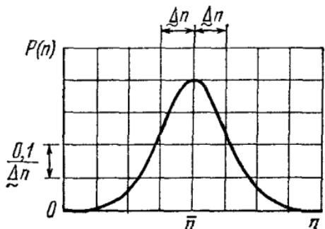
Рис. П.1. Гауссовское распределение плотности вероятности  $P(n)$  как функция  $n$ . Вероятность  $W(x)$  того, что  $n$  принимает значение, лежащее между  $\bar{n} - x$  и  $\bar{n} + x$ , определяется площадью под кривой, ограниченной этим интервалом. Вычисления показывают, что если  $\Delta n$  означает стандартное отклонение от  $n$ , то  $W(\Delta n) = 0,683$ ,  $W(2\Delta n) = 0,954$  и  $W(3\Delta n) = 0,997$ .
