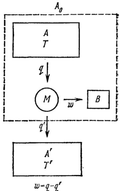
Рис. 7.13. Реальная машина состоит из системы  $A_0$  (см. рис. 7.12), соединенной с дополнительным тепловым резервуаром  $A'$ , абсолютная температура которого меньше температуры теплового резервуара  $A$ .
