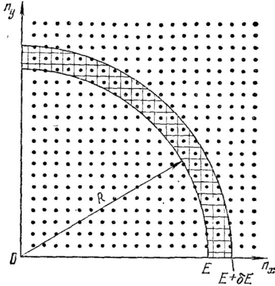
Рис. 3.7. Точками схематически (в двух измерениях) показаны возможные значения  $n_x, n_y, n_z = 1, 2, 3, 4, \dots$  квантовых чисел, определяющих состояние одиночной частицы в трехмерном ящике. (Ось  $n_x$  направлена перпендикулярно к плоскости рисунка.) Значения  $n_x, n_y$  и  $n_z$ , соответствующие энергии частицы в интервале от  $E$  до  $E + \delta E$ , лежат между двумя сферическими поверхностями. Точки внутри сферы соответствуют всем значениям  $n$ , для которых энергия меньше  $E$ .
