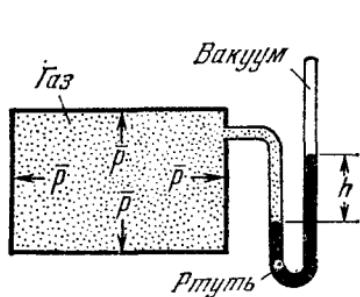
Рис. 1.33. Среднее давление газа  $\bar{P}$  измеряется при помощи манометра, состоящего из U-образной трубы, наполненной ртутью. В трубке устанавливается такая высота  $h$  столбика ртути, чтобы давление, оказываемое этим столбиком, уравновешивалось давлением газа.
