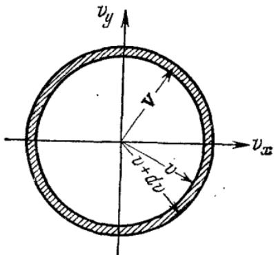
Рис. 6.6. Пространство скоростей для двух измерений (ось  $v_z$  перпендикулярна к плоскости чертежа). Сферический слой содержит все молекулы, скорость которых  $\mathbf{v}$  такова, что  $v < |\mathbf{v}| < v + dv$ .
