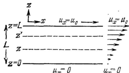
Рис. 8.4. Жидкость, заключенная между двумя пластинами. Нижняя плата неподвижна, а верхняя движется со скоростью  $u_0$  в направлении  $x$ ; таким образом, в жидкости существует градиент скорости  $du_x/dz$ .
