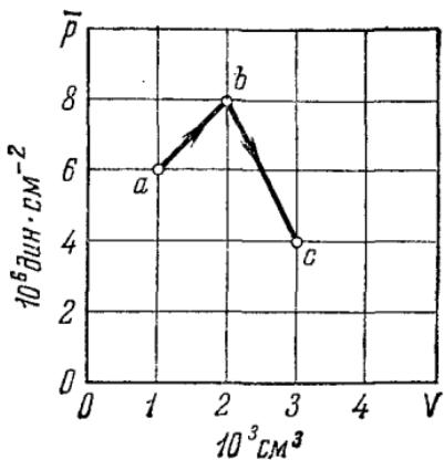
Рис. 7.14. Некоторый процесс, изображенный на диаграмме: среднее давление  $p$ , объем  $V$ .
