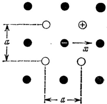
Рис. 4.14. Атомы примеси в кристаллической решетке твердого тела.
