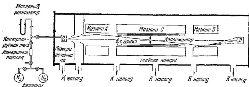
Рис. 6.13. Схема основных частей прибора, показанного на предыдущей фотографии. Кон-
