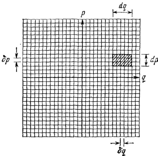
Рис. 6.4. Пример двумерного фазового пространства, разделенного на малые ячейки равного «объема»  $\delta q \delta p = h_0$ . Заштрихованная область соответствует элементу объема величиной  $dq dp$ , содержащему много ячеек.
