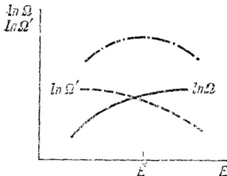
Рис. 4.3. Зависимость  $\ln \Omega(E)$  и  $\ln \Omega'(E') \equiv \ln \Omega'(E^* - E)$  от энергии  $E$ . Из (3.38) следует, что  $\ln \Omega(E) \sim f \ln(E - E_0) + \text{const}$ . Обе кривые обращены выпуклостью вверх и их сумма (показанная штрих-пунктирной линией) имеет единственный максимум при некотором значении  $\tilde{E}$ . Широкий максимум для медленно меняющегося логарифма  $P(\tilde{E})$  в формуле (6) соответствует крайне резкому максимуму самой величины  $P(E)$ .
