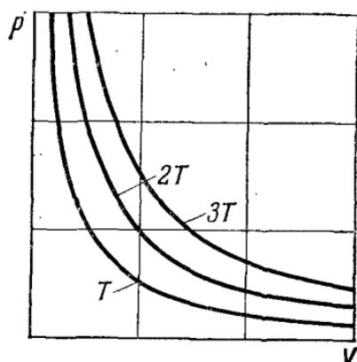
Рис. 4.13. Зависимость среднего давления  $p$  идеального газа от объема при абсолютных температурах  $T$ ,  $2T$  и  $3T$ .
