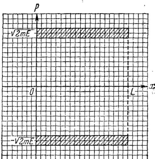
Рис. 6.3. Классическое фазовое пространство частицы, движущейся в одном измерении в ящике длиной  $L$ . Состояние частицы характеризуется координатой  $x$  и импульсом  $p$ ; ее энергия лежит между  $E$  и  $E+\delta E$ . Состояния, доступные частице, соответствуют ячейкам, находящимся в заштрихованных областях.
