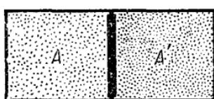
Рис. 1.29. Сжатый газ  $A'$  совершает работу над газом  $A$  при макроскопическом перемещении поршня.
