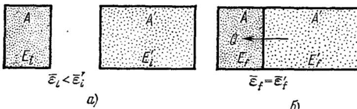
Рис. 1.31. Два газа,  $A$  и  $A'$ , состоящие из одинаковых молекул, первоначально не находятся в контакте друг с другом (а). Затем они приводятся в тепловой контакт (б) и обмениваются теплом до тех пор, пока не будет достигнуто равновесие. Энергия газа обозначена через  $E$ , а средняя энергия одной молекулы через  $\bar{e}$ .
