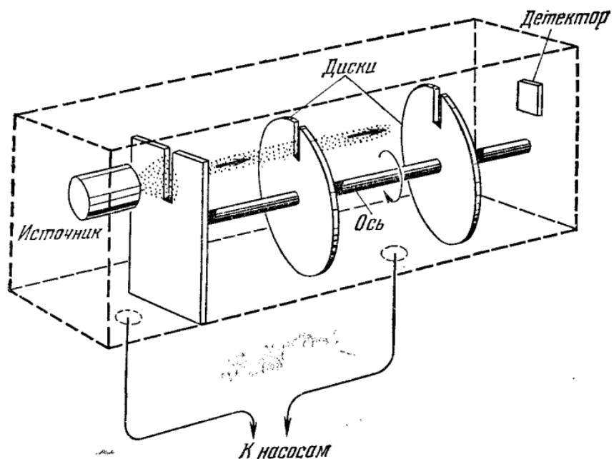
Рис. 6. 11. Схема прибора с молекулярым пучком и селектором скоростей для изучения распределения скоростей молекул. За время, необходимое пучку, чтобы пройти расстояние между первым и вторым диском, ось повернется на определенный угол и пучок пройдет через диск только в том случае, если диск совершил полный оборот (или целое число полных обработов).
