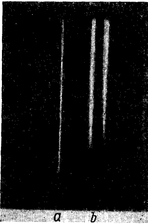
Рис. 3. Расщепление пучка паров натрия в магнитном поле:
