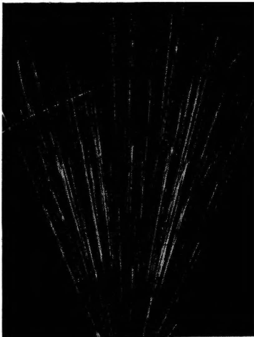
Фото 7. Распад ядра азота в результате столкновения с \alpha -частицей. При этом испускается протон с очень большой энергией. Можно видеть две категории \alpha -частиц, излучаемых смесью тория В и С: высокоэнергетические и низкоэнергетические \alpha -частицы (см. стр. 90).
