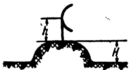
Рис. 4.25. К выбору позиции радиолокатора. Увеличение дальности при малых углах возвышения.
