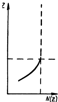
Рис. 8.3. Возможное распределение концентрации электронов по высоте, определенное по z_d(f) .
