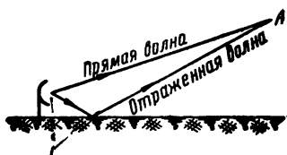
Рис. 1. Влияние земли на распространение радиоволн.
