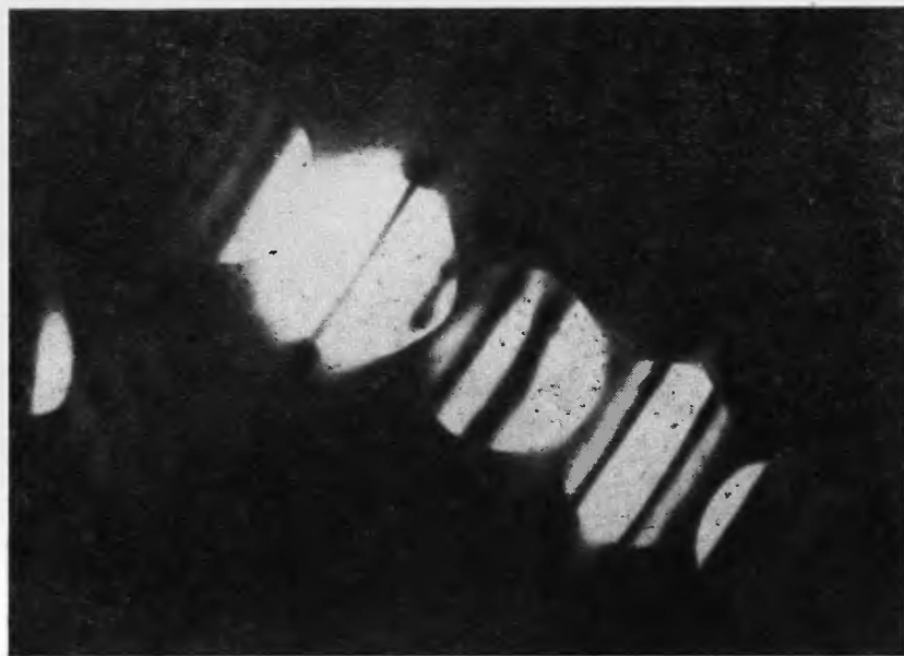
Фиг. 9.5. Дифракционная картина в сходящемся пучке для тонкого совершенного кристалла MgO, показывающая вариацию интенсивности в зависимости от угла падения для отражений 2h, 0, 0 .
