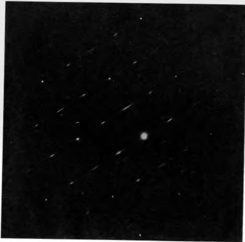
Фиг. 18.1. Электрограмма от кристалла фторогерманата магния, показывающая вытягивание пятен вдоль направления c^* , связанное с плоскими дефектами в кристалле. (Любезно предоставлена П. Кунцманом.)
