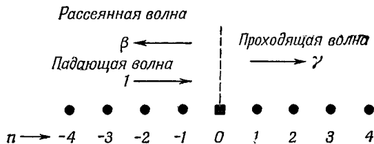
Ф и г. 11.6. Волны в одномерной решетке с одним «примесным» атомом в n = 0 .
