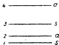
Фиг. 22. Последовательность симметричных ( s ) и антисимметричных ( a ) ротационных уровней в основном состоянии молекулы водорода.
