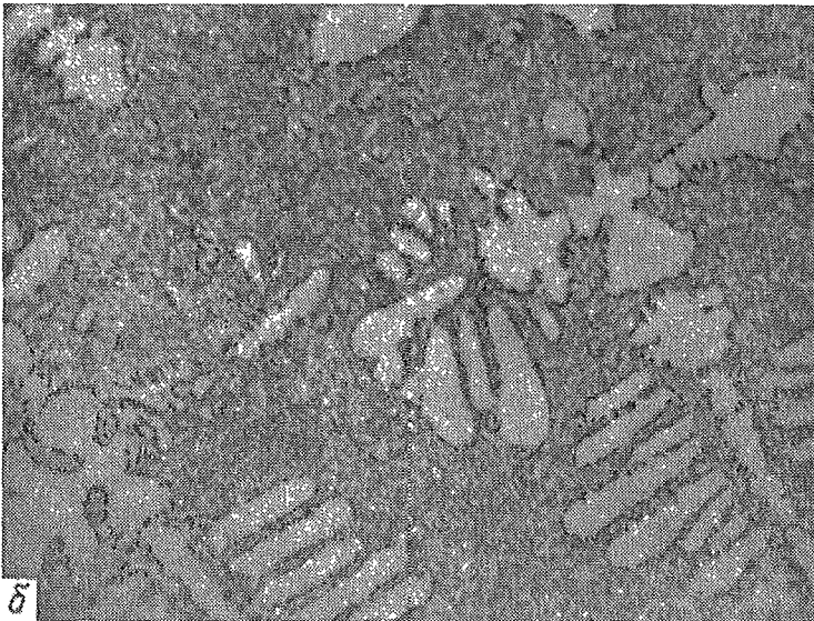
Фиг. 6.5. Эвтектика в сплаве системы Al — Si, \times 200 (из работы Дэй и Хеллауэлла [4]). a — кремний присутствует в виде ограниченных пластинок; б — кремний присутствует в стержневидной форме; видны первичные дендриты алюминия.
