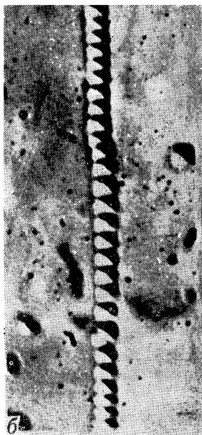
Рис. 6. Схема простой дислокационной границы ( a ) и реальная дислокационная граница в монокристалле LiF ( б ), проявленная травлением. Увеличение 300.
