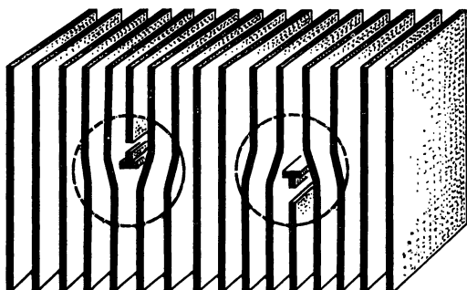
Рис. 2. Схематическое изображение краевых дислокаций двух различных знаков. Значок \perp обозначает краевую дислокацию. Пунктирной окружностью выделена искаженная область, прилегающая к дислокации.
