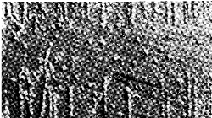
Рис. 3. Дислокационная структура изогнутого кристалла цинка. Упорядоченные ряды дислокаций расположены в растянутой и сжатой областях кристалла.
