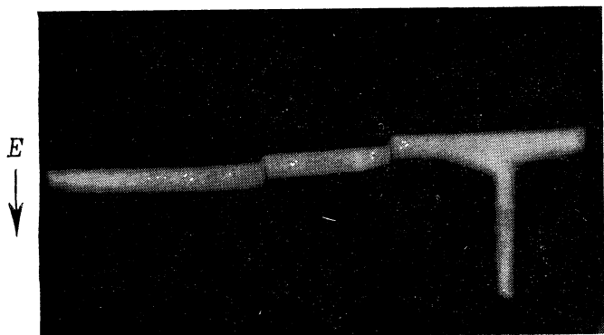
Рис. 64. «Хрупкое» разрушение иглоподобной поры в монокристалле фтористого лития в электрическом поле. Увеличение 250.
