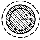
Рис. 1. Пульсирующая сфера (монополь).
