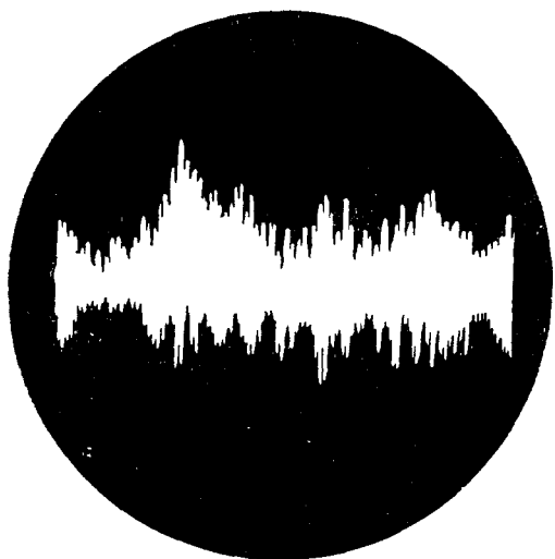
Рис. 416. Наблюдение шума радиоприемника с помощью электронного осциллографа.
