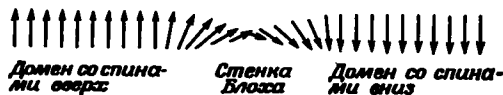
Ф и г. 149. Стрелкам отвечают магнитные моменты отдельных атомов. Переходная область между двумя доменами с противоположными направлениями намагниченности называется стенкой Блоха.
