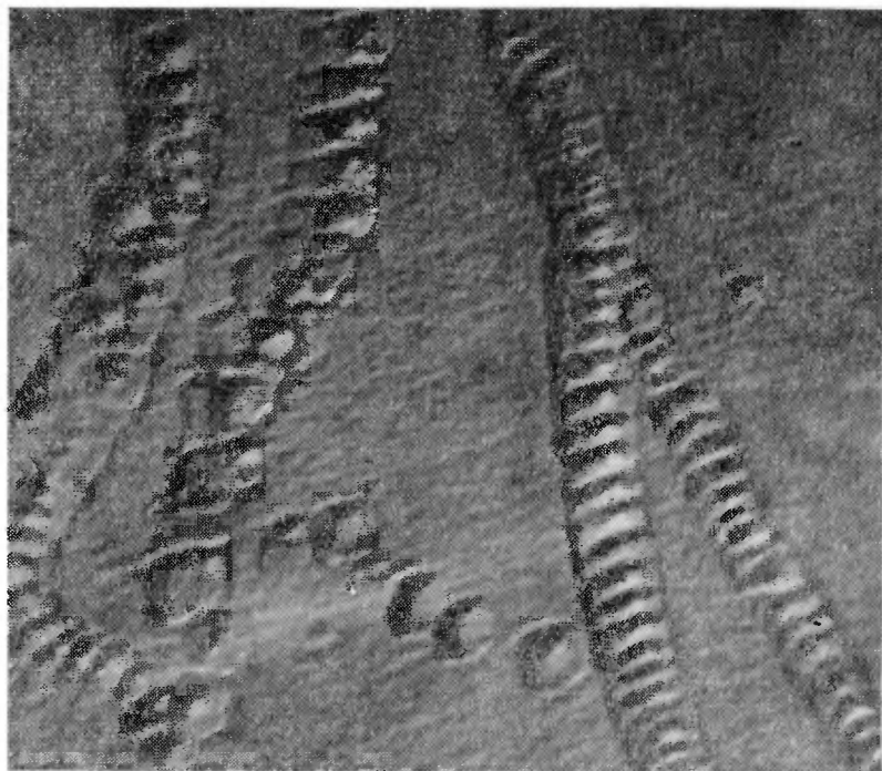
Рис. 67. Малоугольные границы зерен в чистом железе после полигонизации. Дислокации, образующие эти границы, выявляются травлением в виде ямок. \times 7200 (по Босуэллу)
