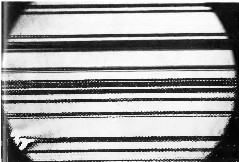
6А. Скопления линий скольжения в сплаве \text{Cu} - \text{Ni} . \times 600 (Р. А. Фоксгал).
