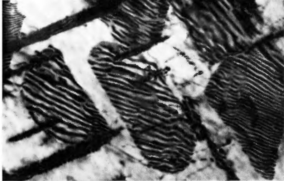
12А. Межграницные дислокации в пластинчатых выделениях в сплаве Al — Cu. \times 90\,000 (Л. Г. Бонар).
