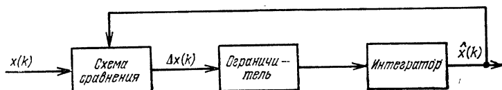
Рис. 3.2.3. Схема квазилинейного измерителя квадратурной составляющей сигнала.
