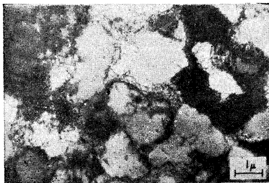
Рис. 20.16. Ячеистая структура, образованная трехмерными сетками дислокаций в деформированном кристалле алюминия. (P. R. Swann.)
