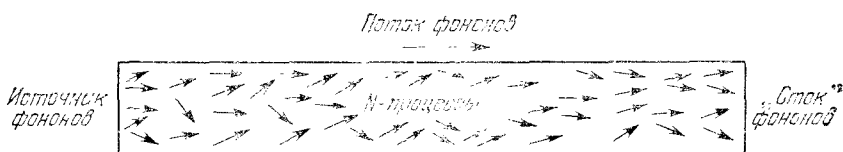
Рис. 6.21в. В длинном кристалле можно создавать фононы главным образом на одном из концов, как если бы мы «осветили», например, левый конец «фононной лампой». От этого конца в кристалле к правому его концу потечет поток фононов. Если в кристалле происходит только обычные (нормальные) процессы рассеяния ( N -процессы), при которых K_1 + K_2 = K_3 , то поток фононов сохранит при столкновениях неизменный полный импульс и часть фононов пройдет через кристалл на всю длину. Большую часть энергии фононов, приходящих к правому концу, можно, в принципе, преобразовать в излучение, создавая тем самым «сток» для потока фононов. Так же как и в случае (а), тепловое сопротивление равно нулю.
