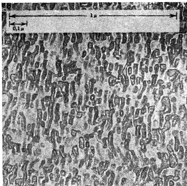
Рис. 16.39. Микрофотография поверхности образца сплава алнико-V. Структура — оптимальная для использования сплава в качестве материала для постоянных магнитов. Состав сплава алнико-V: Al (8%), Ni (14%), Co (24%), Cu (3%), Fe (51%) (проценты весовые). В качестве материала для постоянных магнитов используется двухфазная система, в которой мелкие частицы одной фазы распределены в другой фазе. Выпадение мелкой фазы происходит в магнитном поле, и поэтому частицы ориентируются так, что их продольные оси параллельны направлению поля. (Из работы Люборского.)
