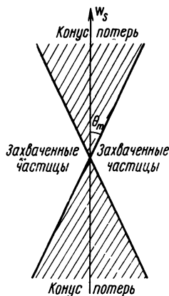
Рис. 7.4. Конус потерь в пространстве скоростей для ловушки с магнитными пробками.
