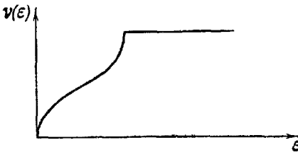
Рис. 13. Поведение плотности состояний при переходе от эллипсоидальных изоэнергетических поверхностей к тороидам.
