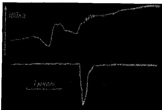
Рис. 35.6. Осциллограммы разрядного тока (верхний луч) и нейтронного импульса (нижний луч). Сдвиг между началом роста тока после второй особенности и началом нейтронного импульса равен сумме пролетного времени нейтронов ( \approx 30 \text{ нсек} ) и времени задержки сигнала в ФЭУ ( \approx 15 \text{ нсек} ). U_0 = 30 \text{ кВ} , P_0 = 6 \cdot 10^{-3} \text{ мж рт. ст.}
