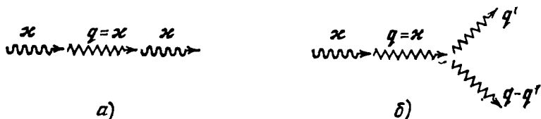
Рис. 67. Поглощение фотона, связанное с испусканием фонона: а) в последующем процессе фотон реэммитируется, б) в последующем процессе фотон распадается на два фонона меньшей энергии; только в результате этого энергия фотона окончательно извлекается из поля излучения.
