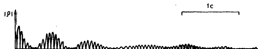
Рис. 3. Модуль коэффициента корреляции |\rho| = g(\tau)/g(0) ( H_1=4,524 ; H_2=4,564 )
