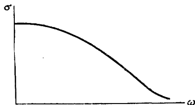
Фиг. 8.14. Зависимость проводимости от частоты, обусловленная внутризонным поглощением или поглощением на свободных носителях.
