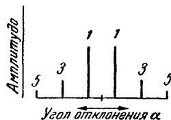
Рис. 170. Спектральные линии, создаваемые решеткой S_r с неизвестным профилем ослабления.
