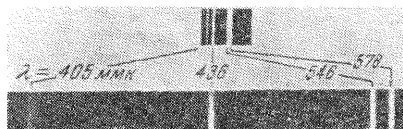
Рис. 281. К демонстрационному опыту, показывающему, что в спектральной области, расположенной по соседству с крутым подъемом собственного поглощения, имеется сильная дисперсия.
