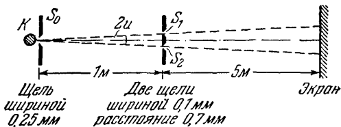
Рис. 126. Схема интерференционного опыта Томаса Юнга.
