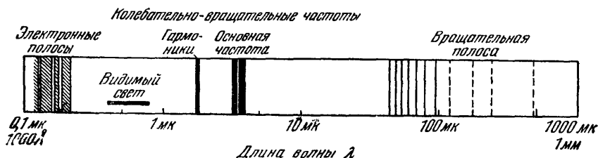
Рис. 372. Общий вид спектра поглощения HCl, т. е. полярной двухатомной молекулы.
