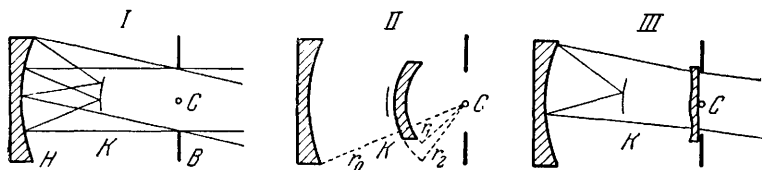
Рис. 92. Принцип свободного от комы зеркала Шмидта и его вариантов.
