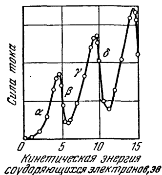
Рис. 330. Периодическое появление медленных электронов при возбуждении резонансной линии ртути (254 мкм) электронным ударом.
