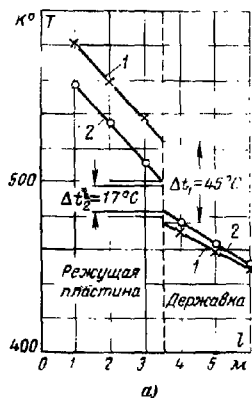
Рис. 6-6. Распределение температур в ноже и державке сборного резца с внутренним охлаждением при точении (а) по показаниям потенциометра (б).
