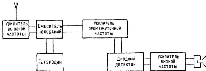
Рис. 430. Блок-схема супергетеродинного приемника.
