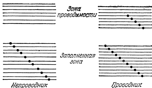
Рис. 115. Энергетические схемы непроводника и проводника.
