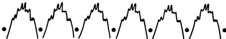
Фиг. 2.3. Одномерная решетка с произвольным периодическим потенциалом, создаваемым ионами в узлах решетки.
