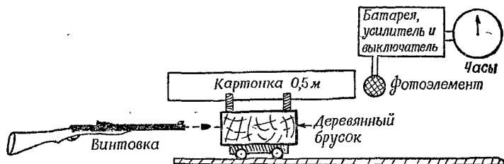
Фиг. 201. Измерение скорости ружейной пули на основе сохранения количества движения.
