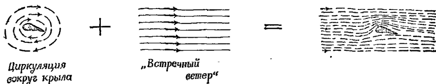
Фиг. 251. Идеализированная картина ламинарного потока. При действительном полете позади самолета образуется вихревое движение.
