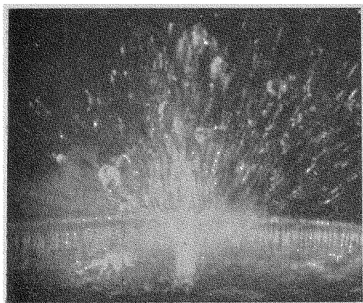
Рис. 23. Разрушение струи фонтана в некоторых режимах распыления
