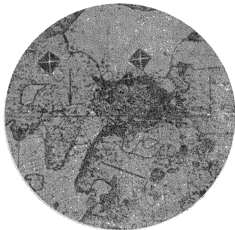
Рис. 58. Участок с повышенной микротвердостью в зоне соединения железа армко
