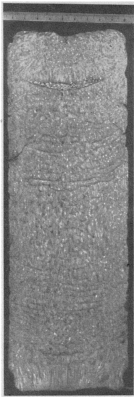
Рис. 44. Макроструктура сплава ЭП-109, обработанного ультразвуком с периодическими зонами и полосчатостью при электрошлаковом переплаве
