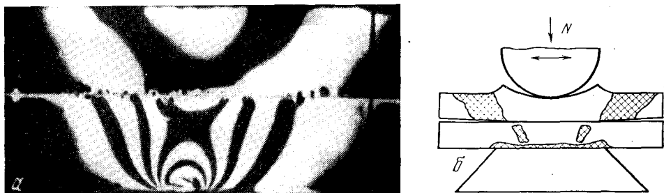
Рис. 8. К объемному деформированию свариваемых деталей
