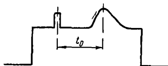
Рис. 170. Искажение формы сигнала из-за модуляции проводимости внутри «пакета».
