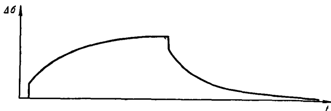
Рис. 78. Кривые релаксации при большой концентрации ловушек.
