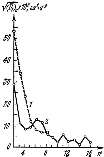
Рис. 55. Изменения средних квадратических значений сферических гармоник \sqrt{(\overline{D_T})_n} для гравитационного потенциала Луны в зависимости от порядков гармоник n . 1 — вычисленного по рельефу Луны, 2 — определенного по наблюдениям ИСЛ.
