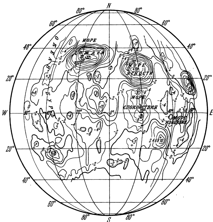
Рис. 20. Карта лучевых ускорений \Gamma для видимой стороны Луны, полученная Мюллером и Сьегреном. По ней впервые были открыты масконы.
