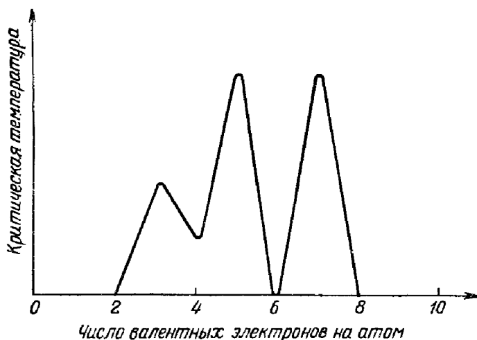
Ф и г. 115. Зависимость критической температуры сверхпроводника от числа валентных электронов на атом.
