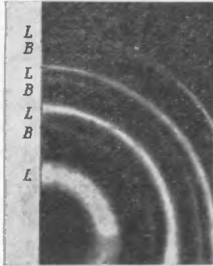
Фиг. 38. Вынужденное рассеяние Бриллюэна в кварце. Снимок интерференционной картины.
