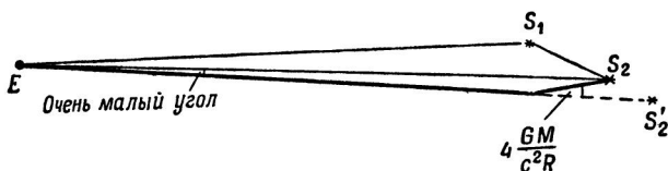
Р и с. 16. Луч света, идущий от компоненты S_2 двойной звезды, искривляется, проходя мимо второй компоненты S_1 . В этом случае S_1S_2 много меньше, чем ES_1 , и угловое смещение S_2 очень мало (ср. с рис. 15).
