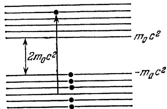
Рис. 22.3. Схема образования пары электрон—позитрон.
