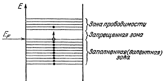
Рис. 28.6. Схема электронной и дырочной проводимости полупроводника.
