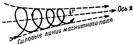
Фиг. 3. Движение частицы в магнитном поле со сходящимися силовыми линиями.
