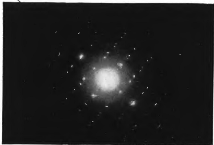
XIX. Электронограмма от игольчатой текстуры мочевины. Тетрагональные кристаллы. Ось текстуры c^* лежит в плоскости подложки. Перпендикулярная съемка.
