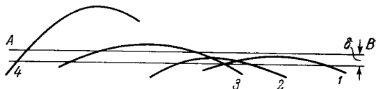
Рис. 13.9. Электронные квазиклассические траектории вблизи граничной поверхности AB металла. 1, 2 — траектории, не обрезаемые граничной поверхностью; 3, 4 — траектории, обрезаемые граничной поверхностью; \delta — толщина скин-слоя (см. [96]).
