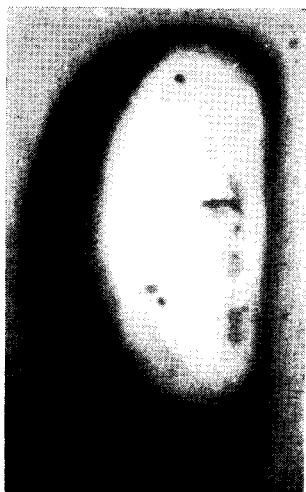
Фото 12. Авторадиограмма образца сплава меди с 10% олова.
