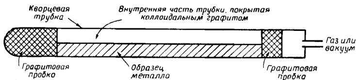
Фиг. 61. Слиток и контейнер, подготовленные для зонной очистки.
