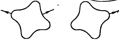
Ф и г. 72. Граница зерен, при пересечении которой частица меняет скорость.
