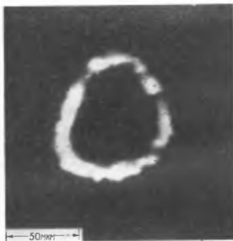
Фиг. 14. Микрофотография поверхности Al, облучаемой ионами Ag^+ , полученная путем регистрации ионов Al^+ [101].
