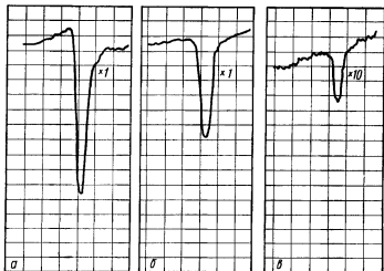
Фиг 16 Спектры полосы поглощения 1730 \text{ см}^{-1} пленки полиметилметакрилата ( 6,8 \text{ мкг/см}^2 , t_e \sim 570 \text{ Å} )
