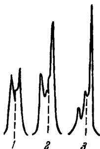
Рис. 22. Распределение освещенности в изображении размытой щели, полученное при распространении ультразвука (1 Мгц ) в воде на расстояниях от источника звука 10 см (1), 50 см (2), 90 см (3). Напряжение на кварцевом излучателе 500 в.
