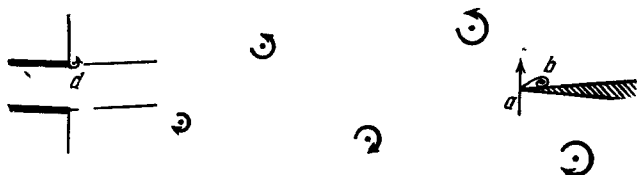
Рис. 97. Схема, поясняющая физический механизм возникновения краевого тона.
