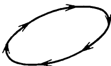
Рис. 3.20. Индекс замкнутой фазовой кривой равен +1
