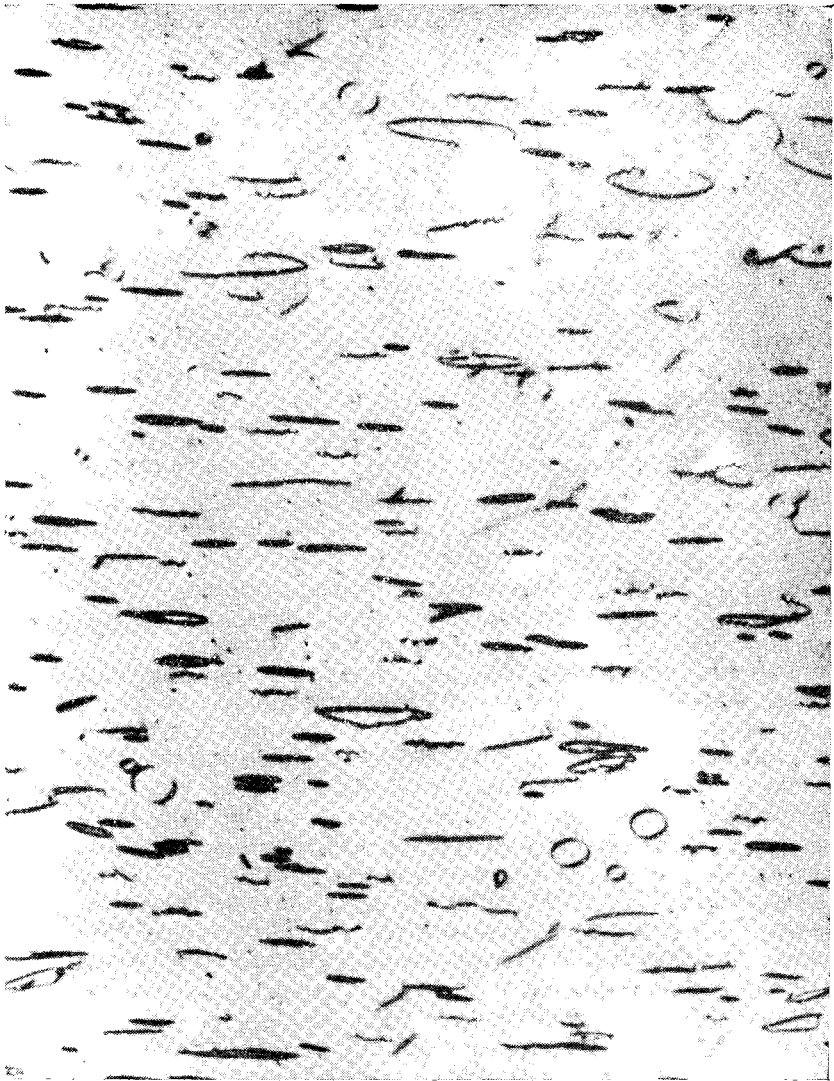
Фиг. 2. Дислокационная структура кристалла германия после отжига при растягивающем напряжении [31].
