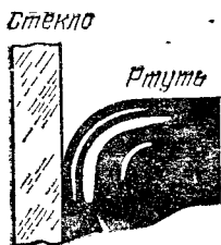
Рис. 413. Так располагается у стеклянной стенки ртути (увеличено)
