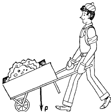
Рис. 139. Тачка как рычаг
