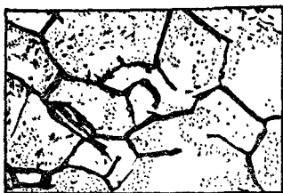
Рис. 456. Шлиф поверхности алюминия. Черные тонкие линии — следы прослоек между кристалликами
