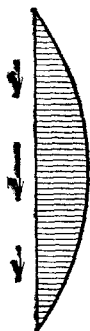
Рис. 117. Ток в вибраторе достигает наибольшего значения в середине и равен нулю на концах
