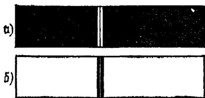
Рис. 327. Спектр испускания (а) и спектр поглощения (б) пара натрия (схематическое изображение). Рисунок имеет цветной дубликат (см. форзац)
