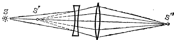
Рис. 202. Превращение расходящегося пучка лучей в сходящийся с помощью вспомогательной собирающей линзы (например, глаза)
